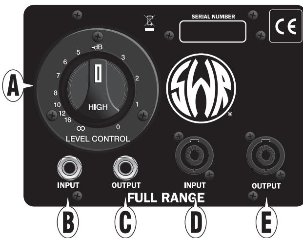
**A. TWEETER-BEDÄMPFUNGSSREGLER** — Mit diesem Regler stellen Sie den Lautstärkepegel des Höhen-Tweeters im Bereich AUS ("∞" = unendliche Bedämpfung) bis maximale Ausgangsleistung ("0" = keine Bedämpfung) ein. Die empfohlene Ausgangsposition ist -4dB (siehe Abb.), die Sie nach Belieben verändern können. **HINWEIS:** Alle auftretenden Übersteuerungen des Verstärkers (Verzerrung) werden vom Tweeter betont. Drehen Sie den Master Volume-Regler Ihres Amps zurück, um das Clipping zu verringern.
