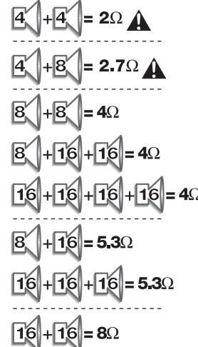
このイラストは、様々なスピーカーの並列接続での合計インピーダンス負荷を示しています。理想的には、合計のインピーダンス負荷がアンプの最小インピーダンス値に一致するアンプをスピーカーに接続するとよいでしょう。▲アンプの最小インピーダンス値以下で使用すると、アンプリファイナーがオーバーヒートしやすくなり、損傷の原因になります。逆に、アンプの最小インピーダンス値以上の使用は、アンプの最大出力能力を減少させます。
