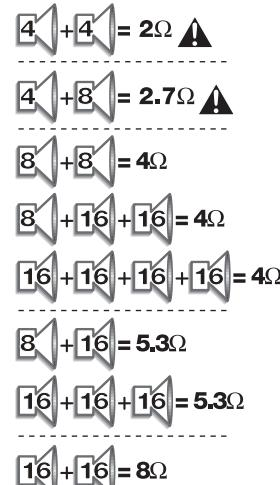
Questa illustrazione mostra il carico d'impedenza totale nell'ambito di varie combinazioni di altoparlanti collegati in parallelo. L'ideale carico d'impedenza totale deve essere uguale al valore d'impedenza minima dell'amplificatore collegato. Operando con un'impedenza inferiore a quella minima dell'amplificatore si rischia di surriscaldare quest'ultimo e di causare dei danni, mentre un'impedenza superiore, sebbene sicura, genera una riduzione della massima potenza in uscita dell'amplificatore.
